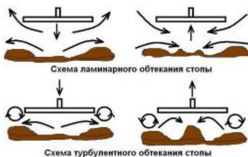
Рис.7. Обобщённые схемы двух режимов вымывания сыпучего грунта.
