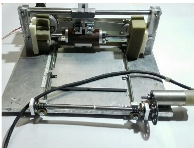
Рисунок 8. Основная часть установки. На каретку, закрепленную на двух трубках, устанавливается обкатывающий инструмент (возможно так же закрепление шариковой ручки)
