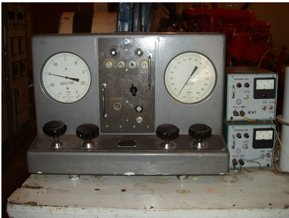
Рис. 4 – Приборы для определения давления газов в цилиндре дизеля
