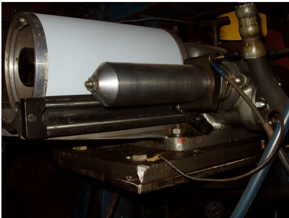
Рис. 5 – Пишущее устройство индикатора МАИ-5А
