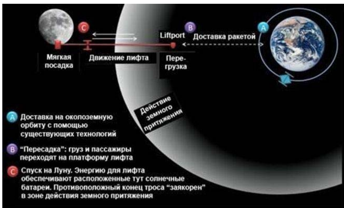
Схема работы лунного лифта.
