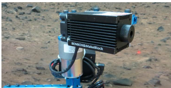
Рисунок 6. Поворотный механизм лазерной установки
