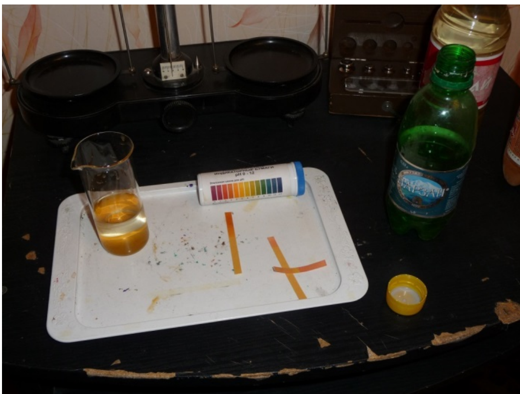
Рис. 4 Определение кислотности образцов подотвальных вод.
