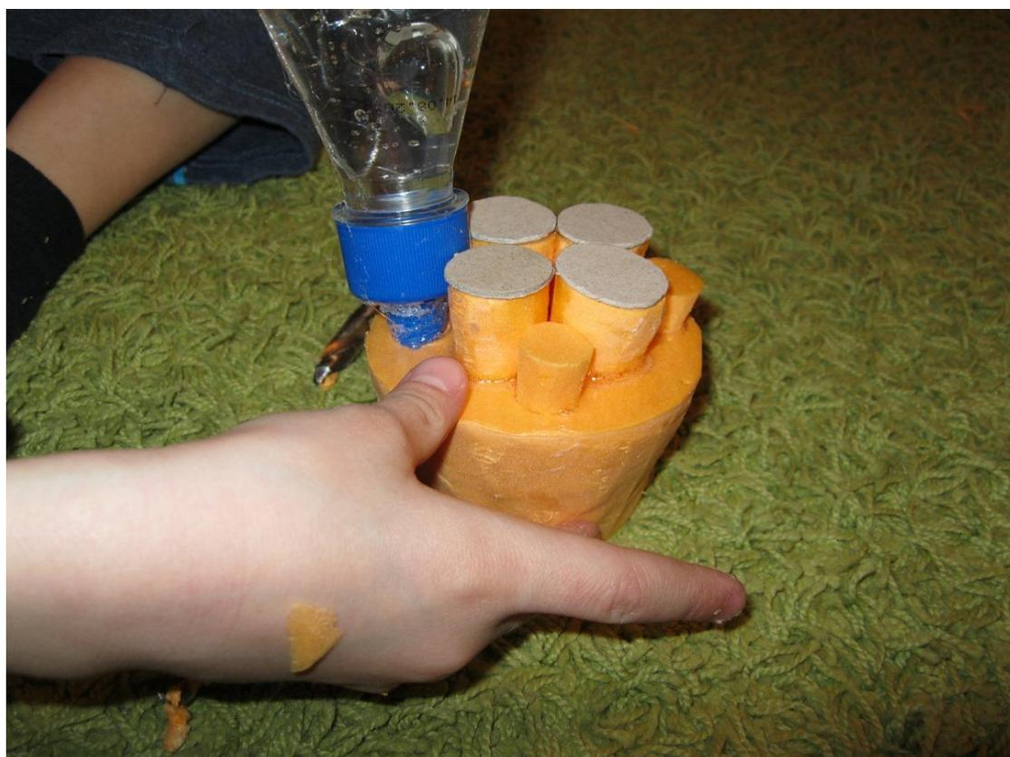
Рисунок 9. Приклеивание сопла к основанию
