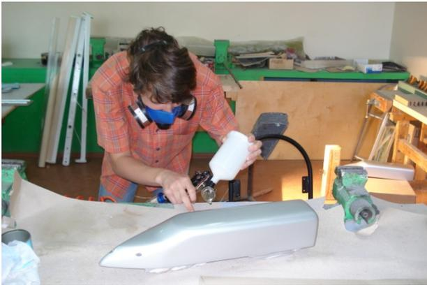
Нанесение на корпус модели базовой краски и лака
