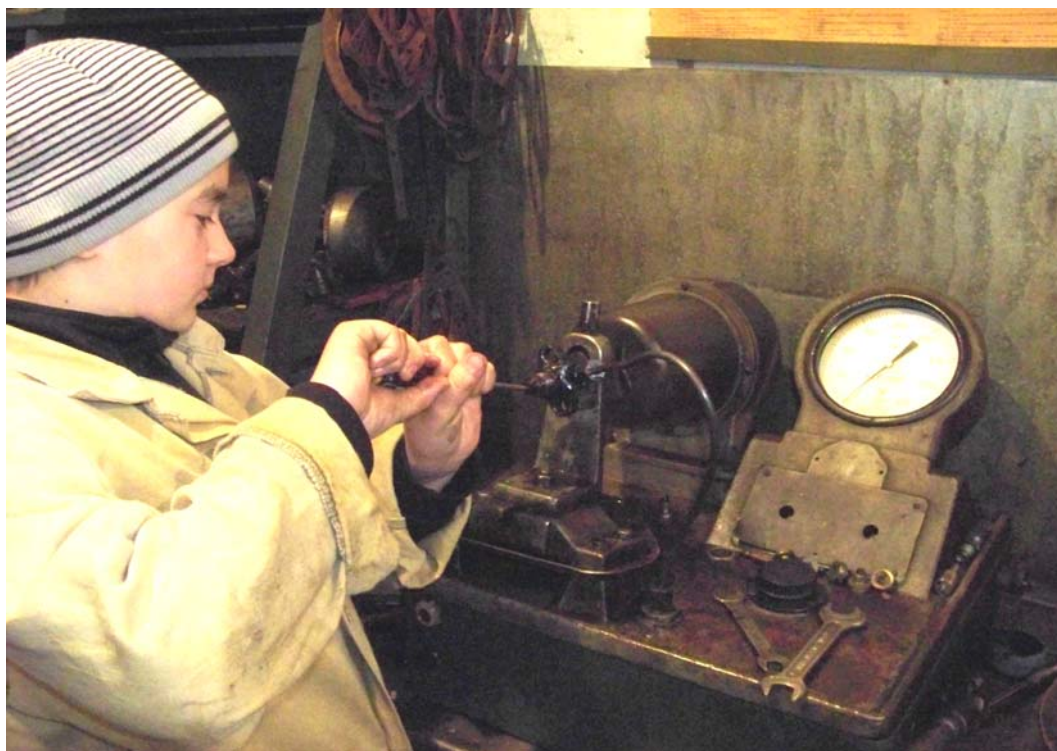
Регулировка форсунки на давление 175 атм.
