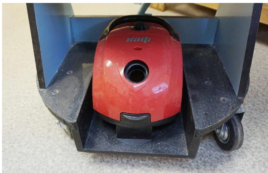
Рисунок 3 – Бытовой пылесос, установленный на самодельном мобильном стружкоотсосе
