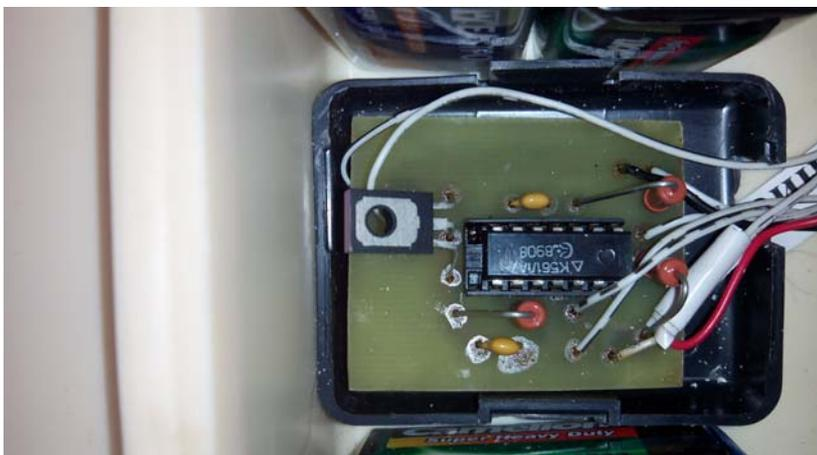
Рис.10. Универсальная плата системы безопасности .
