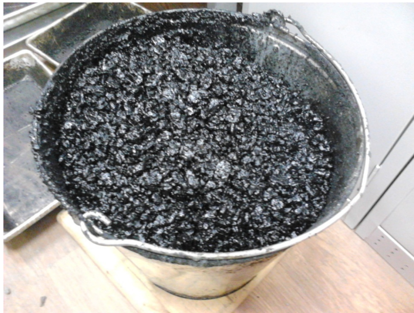
Внешний вид щебеночно-мастичной асфальтобетонной смеси, отобранной из смесительной установки
