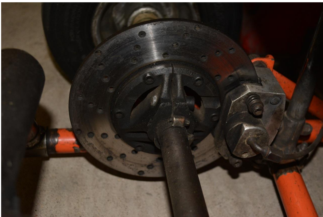
Доработанный диск, установленный на микро гоночном автомобиле «Карт» класса «Национальный»
