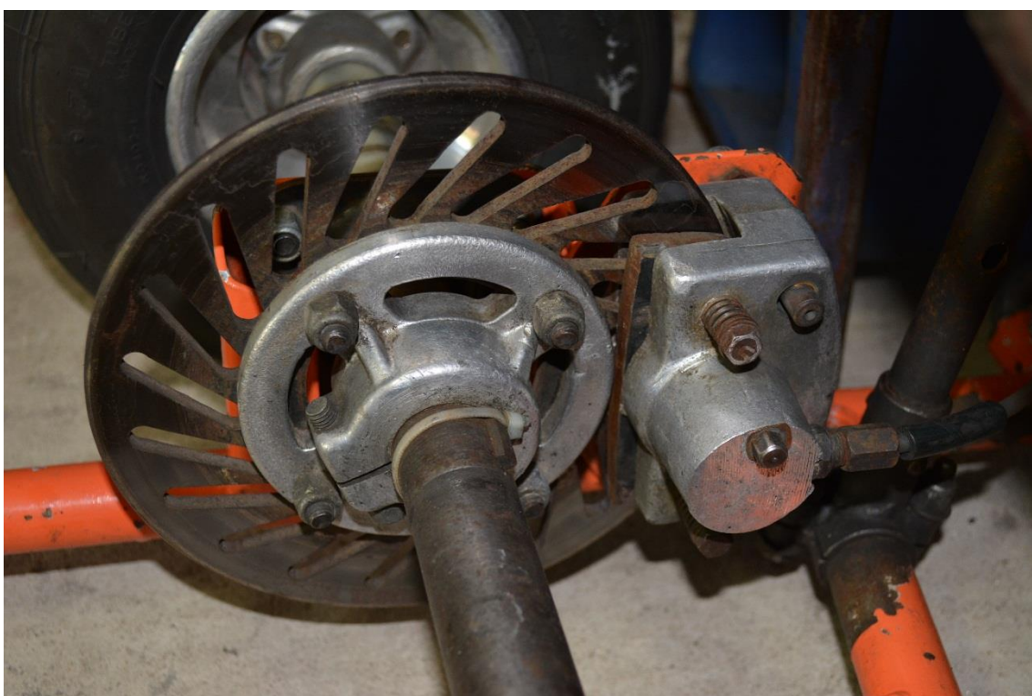
Доработанный диск, установленный на микро гоночном автомобиле «Карт» класса «Национальный-Юниор»
