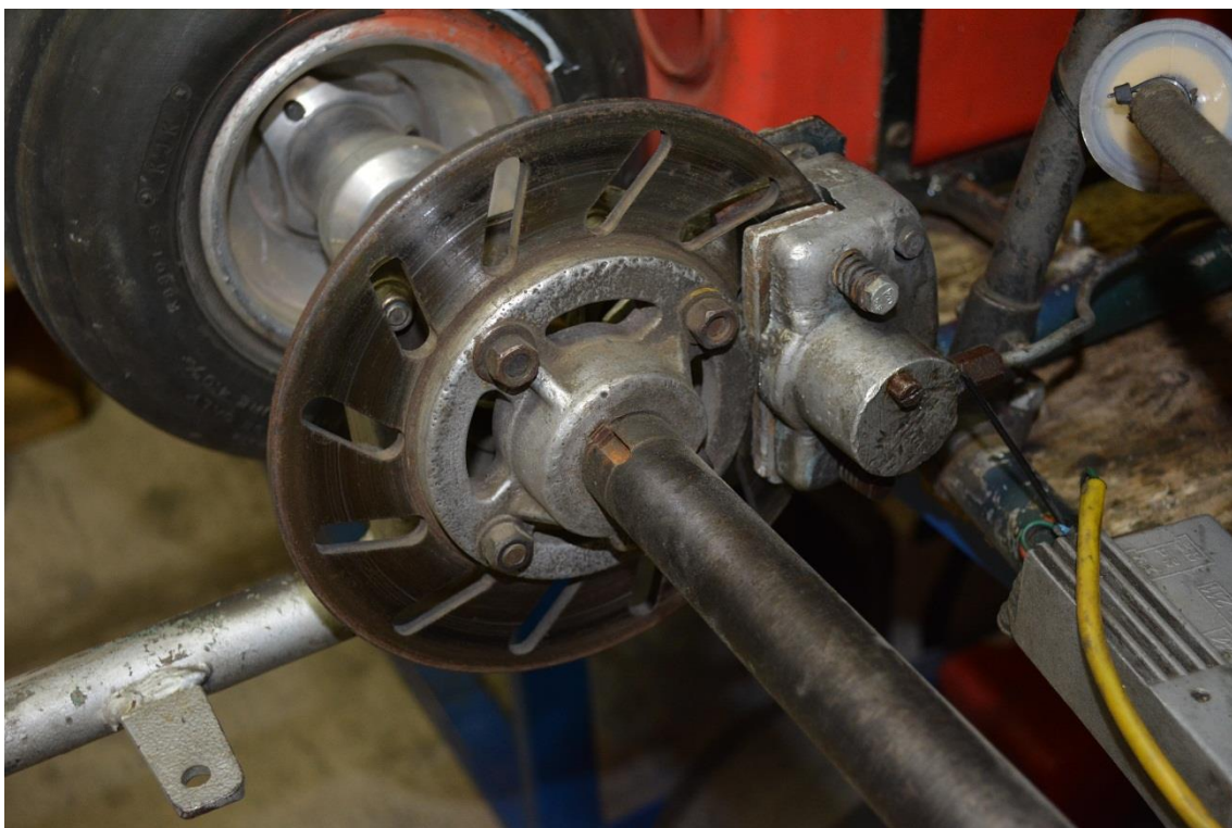
Доработанный диск, установленный на микро гоночном автомобиле «Карт» класса «Пионер-Кадет»
