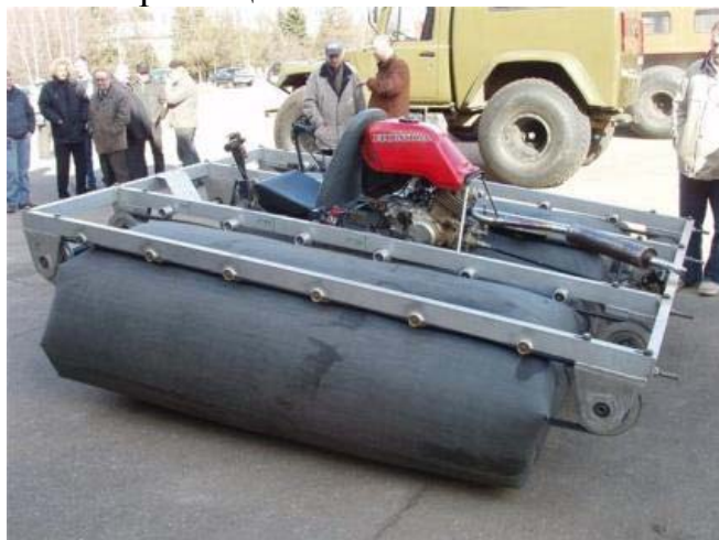
Рис. 1 Экспериментальная тележка конструкции московского института НАМИ.
