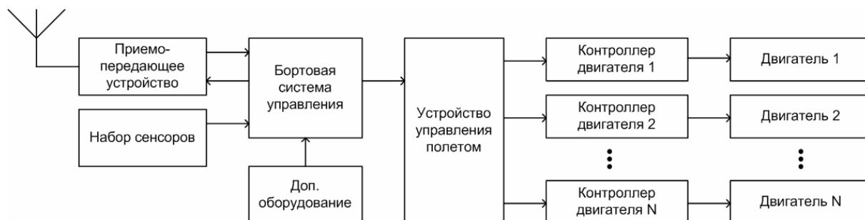
Рисунок 1 – Общая схема квадрокоптера.
