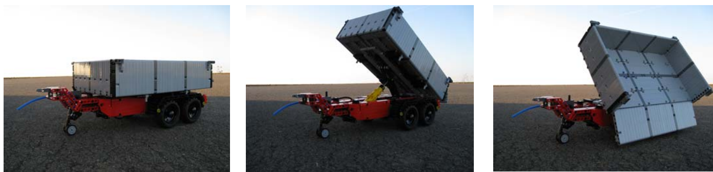
Рисунок 6. Применение пневмопривода для разворачивании платформы
