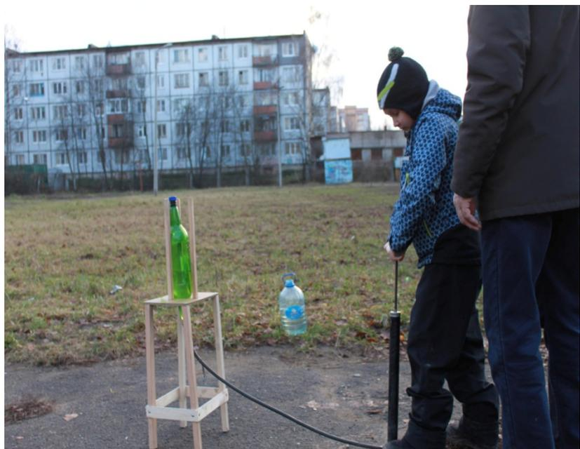
Насосом, присоединенным к ракете, постепенно закачиваем внутрь газ – воздух. Внутри ракеты поднимается давление. Дойдя до определенного уровня, воздух срывает пробку и вырывается наружу, придав ускорение ракете.
