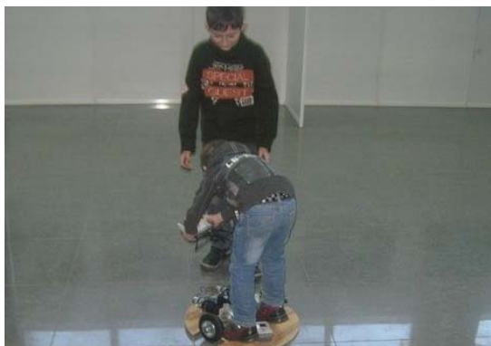
Рис.1. Испытание на грузоподъемность.
