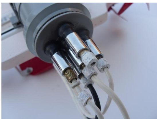
Рис. 5. Автомобильные ниппели. Уплотняющее кольцо на раскрученном ниппеле. Верхний ниппель запасной (для провода от будущих внешних датчиков).
