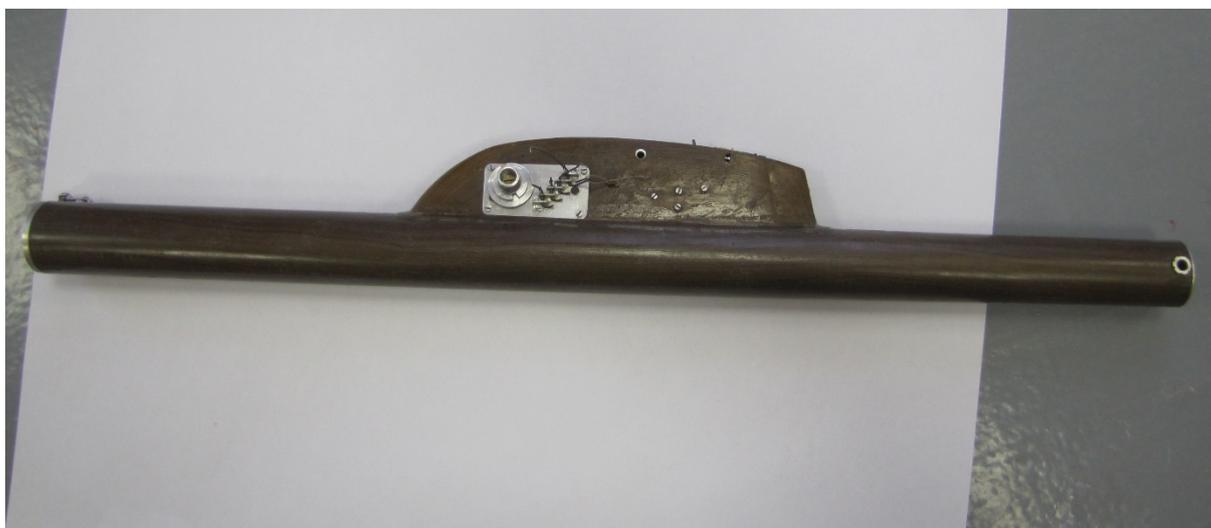
Рис. 2. Фюзеляж резиномоторной модели из органоластика (СВМ)
