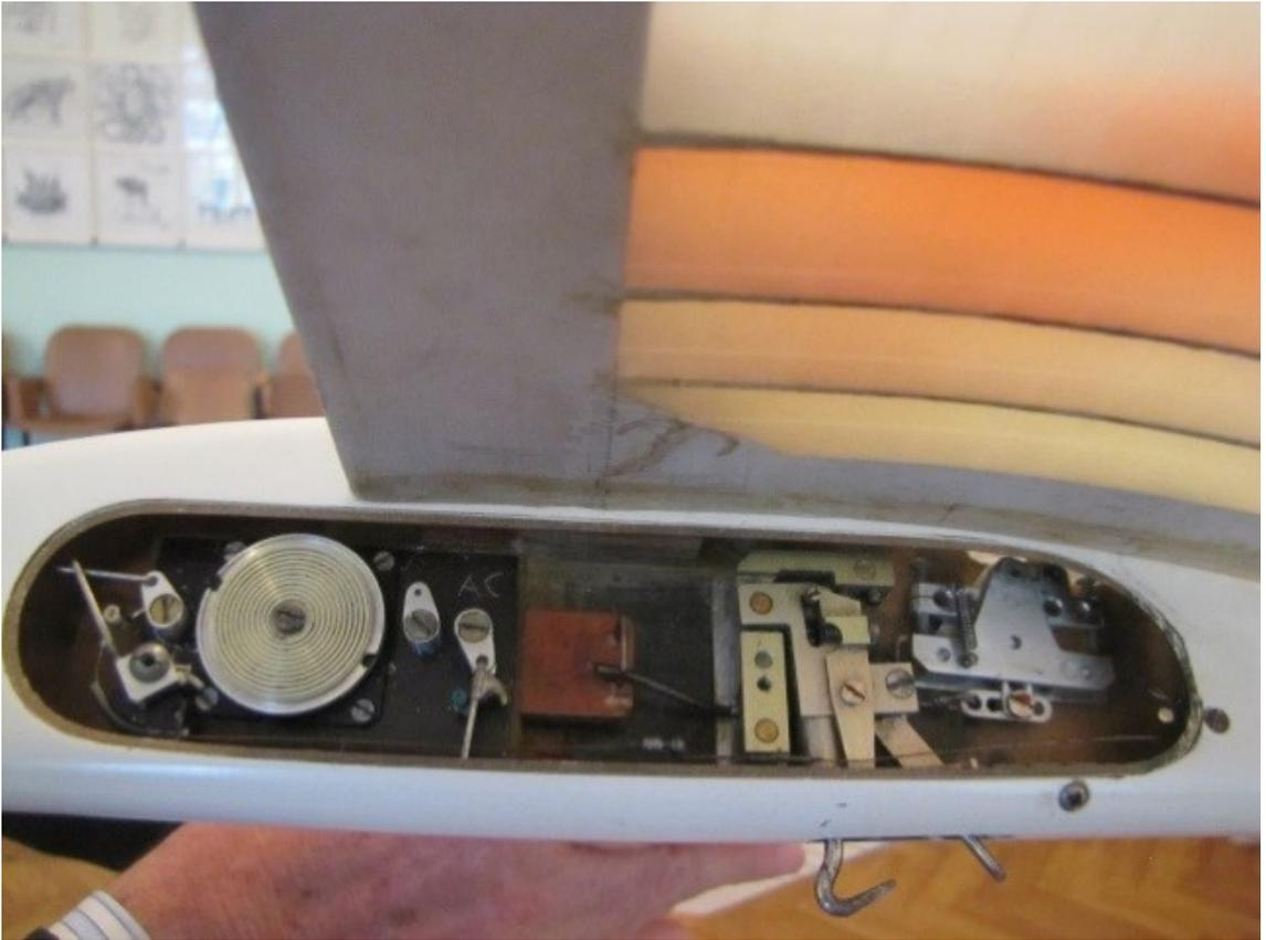
Рис. 1. Программный механизм с крючком на модели планера.
