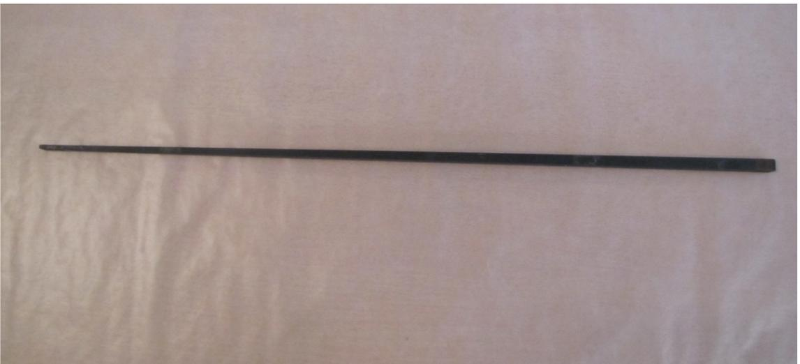
Рис. 2. Лонжерон крыла модели планера из углепластика.
