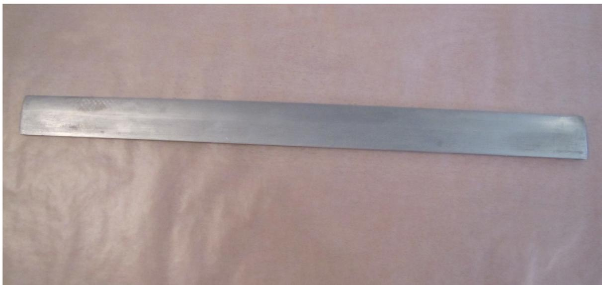
Рис. 2. Оправка для изготовления кессона.
