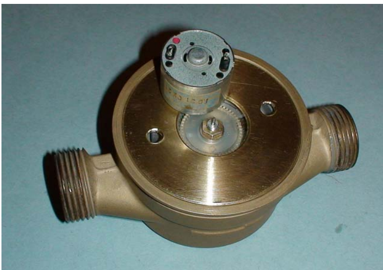
Илл. 5. Устройство со снятой крышкой генераторной камеры.
