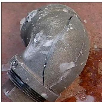
Фото. 1. Лопнувший элемент системы отопления
